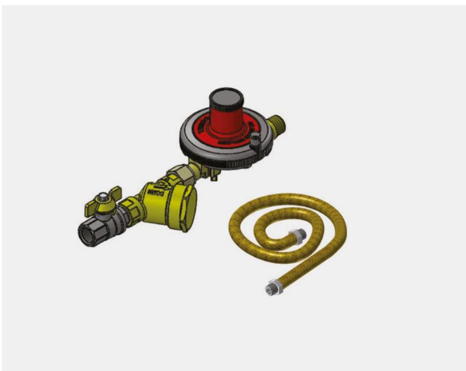
9. Kit alimentazione gas comprensivo filtro gas, regolatore gas bassa pressione, valvola a sfera.
